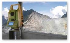
Das autarke trigonometrische System misst laufend die Deformationen des Objektes. Die Korrektur der Standpunktkoordinaten und Refraktionseinflüsse erfolgt direkt am Meßsystem im Feld.
